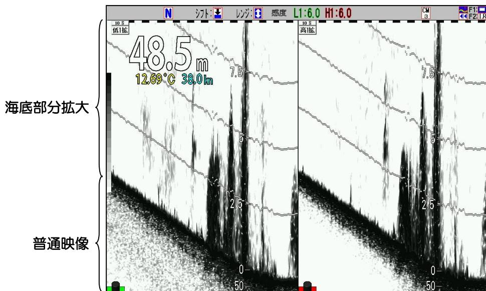
普通映像の海底から上に、指定した拡大レンジで海底から上の映像を合成表示します。
