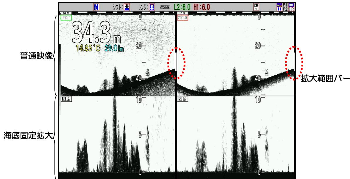
海底を画面の下 10~50%で固定し、そこから上の映像を指定した拡大レンジで表示します。海底上の映像が拡大されるので、底付きの魚群などの識別に有効な拡大モードです。
