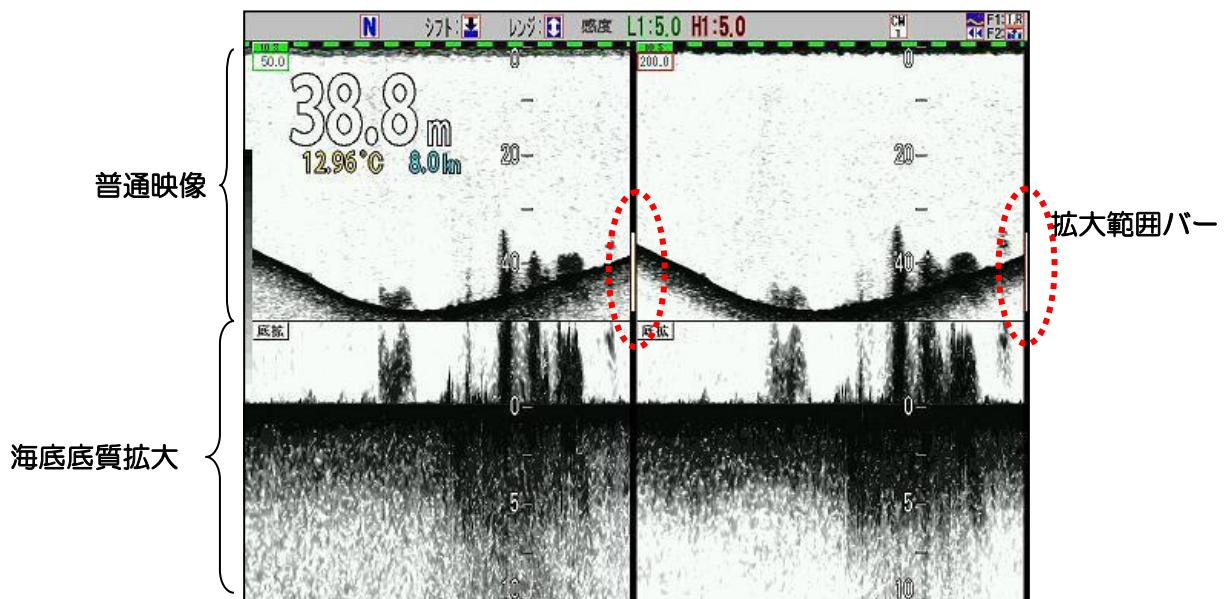
海底を画面の上 10~50%で固定し、海底の映像を指定した拡大レンジで表示します。
