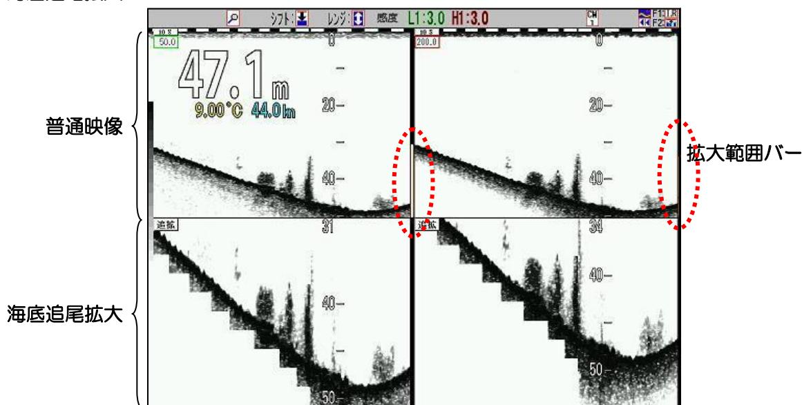
指定した拡大レンジで、画面の上から 30%と 90%の範囲内に海底が表示するよう、自動的にシフト表示します。
